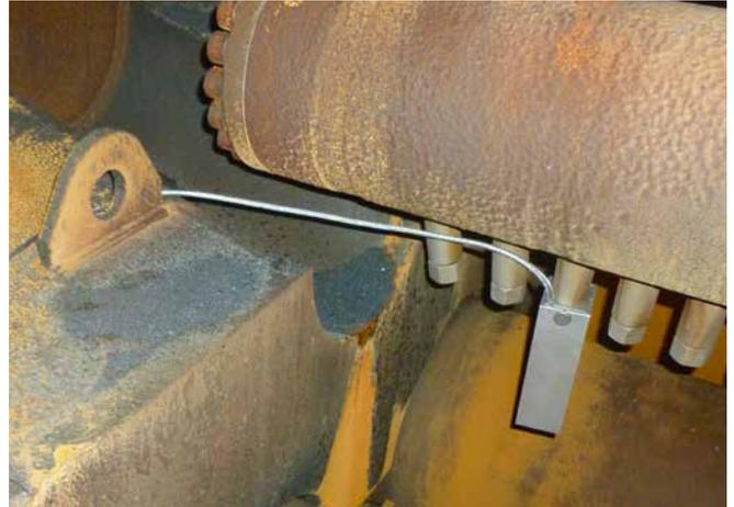
Installationsbeispiel: Drucksensor mit Spritzschutz, montiert auf Spritzbalken
